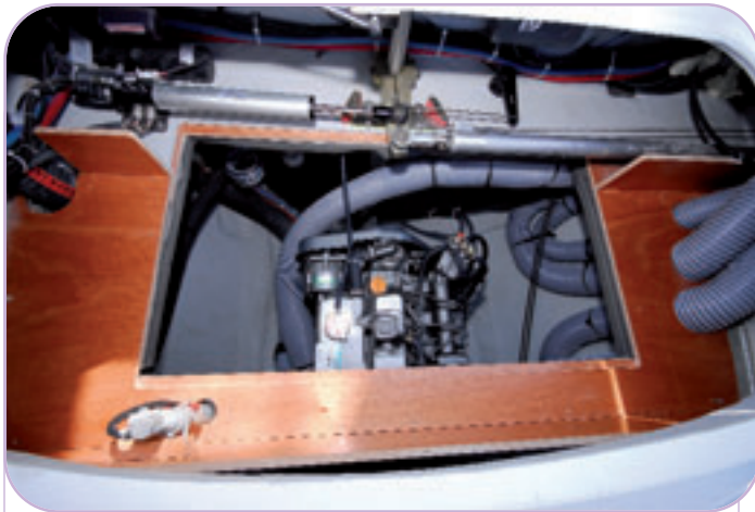
Une cale moteur insonorisée par un faux plancher, l'accès au pilote et à la transmission est soigné.
