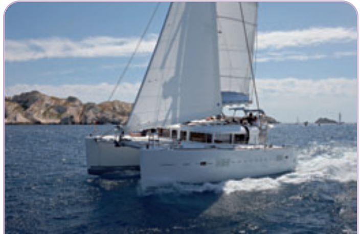
Silhouette plus tranchée, bordés verticaux, bimini bien intégré et plan de voilure copieux, le 400 affirme une personnalité différente de ses prédécesseurs.
